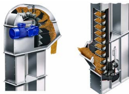
Нории (ковшовые элеваторы) предназначены для подъема зерновых культур, продуктов их переработки, других сыпучих материалов в вертикальной плоскости.
